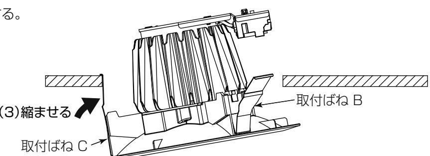
(3) 取付ばね C を縮ませ、埋込穴に挿入する。
