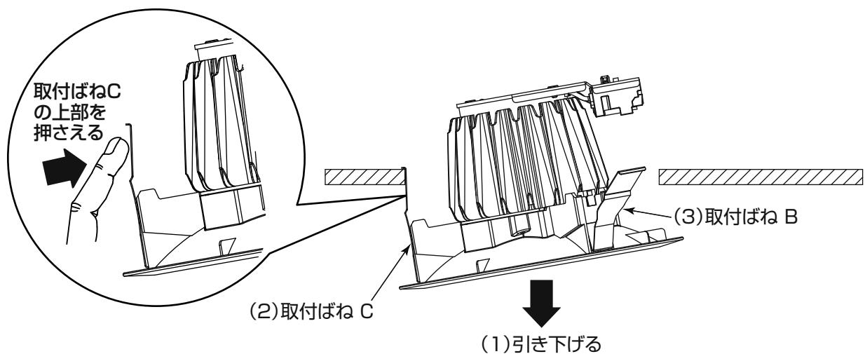
(3) 取付ばね A、B の引掛けりを外し、器具を取り外す。
