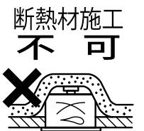
断熱材・防音材を使用する場合は、次の取付条件を守る。
