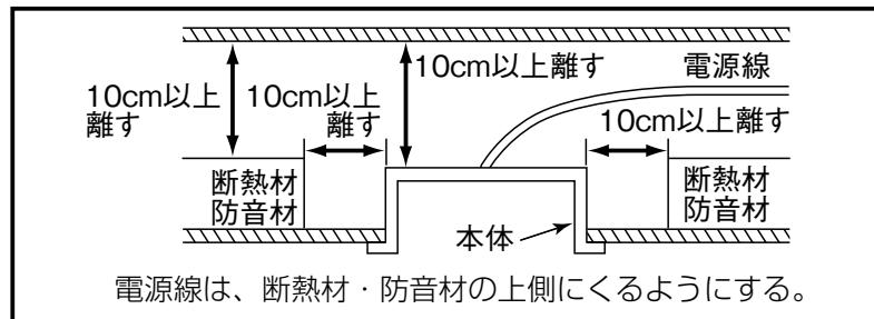
電源線は、断熱材・防音材の上側にくくるようにする。
