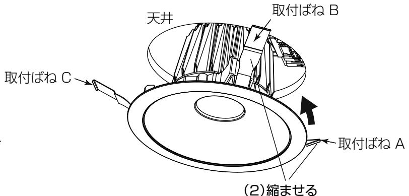
(2) 取付ばね A・B を矢印の方向へ縮ませ、埋込穴に挿入する。
